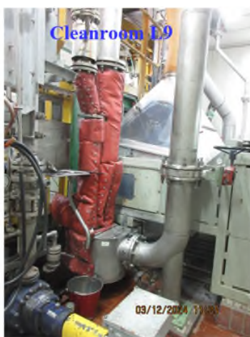
ภาพถ่ายที่ 2.2.2-26 อุปกรณ์ครอบเครื่องจักรที่มีเสียงดัง
